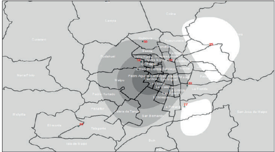
FIGURA 1. Modelo Geoestadístico Kriging para las concentraciones de MP2,5 en la Región Metropolitana
