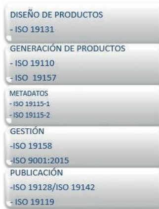
FIGURA N° 1 Clasificación de las normas según el ciclo de vida de un producto. Fuente: Elaboración propia
